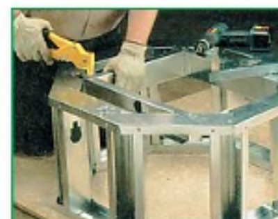
Каркас собирают на заклёпках с отрывным хвостовиком.
