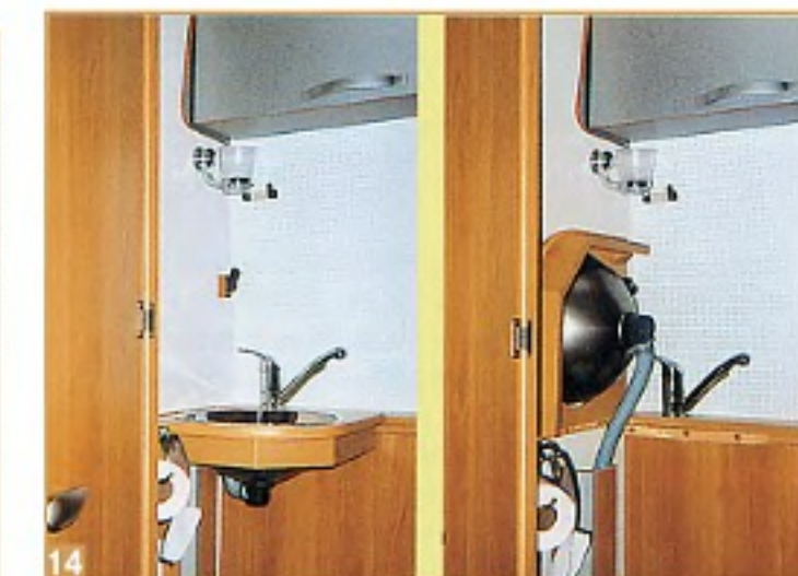
Так выглядит туалетная комната. Раковина умывальника поднимается для обеспечения доступа к унитазу.
