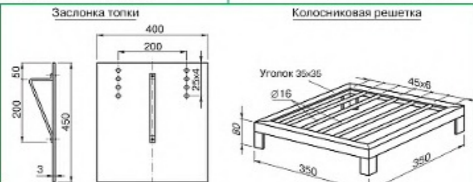
Рис. 2. Самодельные заслонка топки и колосниковая решётка.
