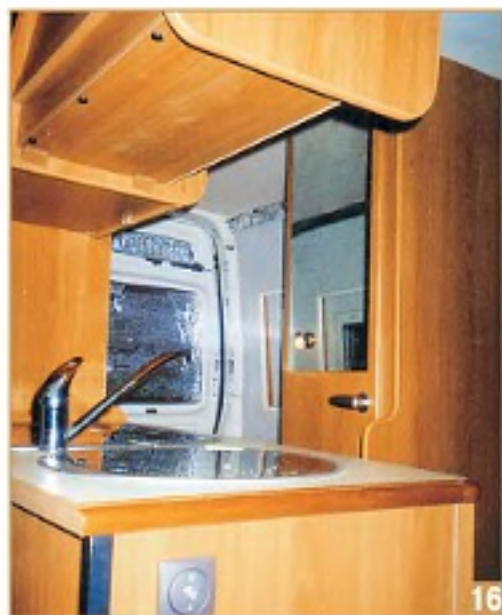
Все углы предметов мебели закруглены, а кромки обклеены кромочным материалом.
